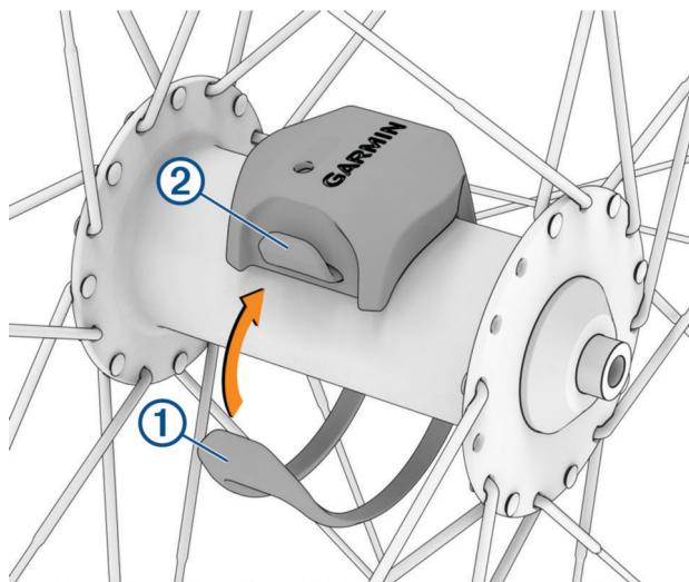
Ak je snímač nainštalovaný na asymetrickom náboji kolesa, môže sa nakláňať. Toto nemá vplyv na prevádzku.
